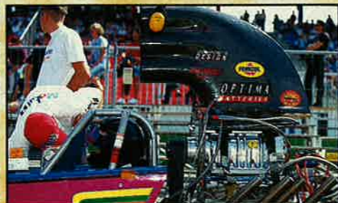
Dank Kompressor und Nitromethan-Treibstoff leisten die V8-Triebwerke bis zu 5500 PS
